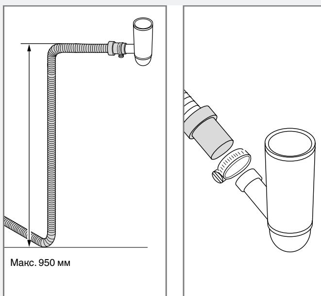
Сливной шланг также может быть подключен к патрубку на сифоне под раковиной. Внутренний диаметр патрубка должен быть не менее 14 мм.
