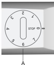
Положение ручки переключателя ближе к 7 означает более низкую температуру (холоднее). Температура в холодильнике может опуститься ниже 0°С. Устанавливайте ручку переключателя ближе к 7, если необходима или рекомендуется более низкая температура охлаждения или температура в помещении, где установлен прибор, ниже +16°С. При нормальной температуре окружающей среды рекомендуется установить среднее значение.
