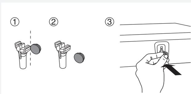
**3** Снимите с втулок заглушки и закройте заглушками три образовавшихся отверстия. Сохраните втулки для возможной транспортировки машины в будущем.
