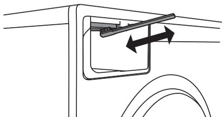
**3** Очистите щеткой отсек дозатора, особенно форсунки в верхней части отсека.
