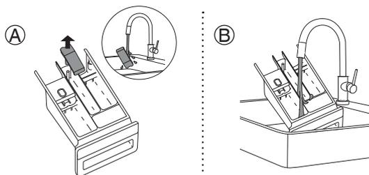
**2** Тщательно очистите и промойте дозатор под проточной водой. Можно снять колпачок дозатора в отделении для кондиционера (А). Промойте и очистите колпачок и внутренние поверхности дозатора от загрязнений.
