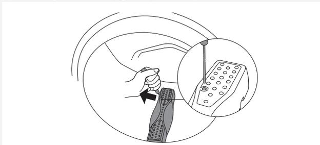
**1** Вставьте в отверстие ребра отвертку или подобный предмет и осторожно нажмите его влево, используя как рычаг.
