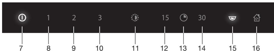
7. Кнопка вкл./выкл. вытяжки; переключает вытяжку в режим ожидания или отключает полностью.
