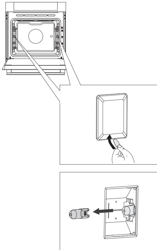
**1** С помощью отвертки снимите крышку.
