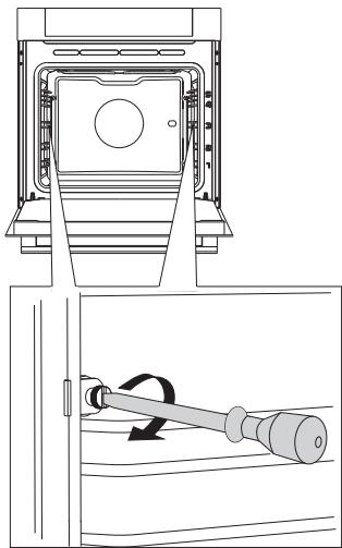
**1** Открутите винт с помощью отвертки.
