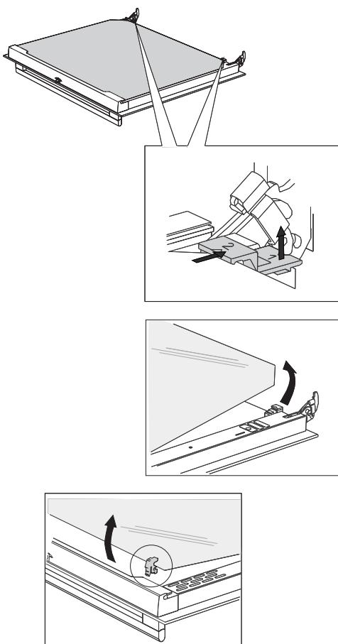
**1** Немного приподнимите фиксаторы с левой и правой стороны дверцы (символ 1 на фиксаторе) и потяните в стороны от стекла (символ 2 на фиксаторе).
