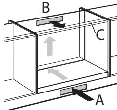
La ventilation s'effectue par la plinthe (A) et le panneau arrière (B) du meuble de cuisine. Pratiquez les ouvertures de ventilation à l'aide d'une scie (min. 100 cm<sup>2</sup>). L'arrivée d'air A est superflue s'il existe une autre ouverture permettant en combinaison avec l'ouverture B, d'aspirer de l'air frais.
