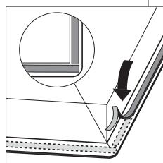
Entfernen Sie die Schutzfolie des Dichtungsstreifens und kleben Sie den Dichtungsstreifen in die Rille der Aluminium- profile oder an die untere Seite der Glasplatte. Das Dichtungsband nicht durch die Ecken kleben, sondern 4 Stücke schneiden, die in den Ecken für eine gute Verbindung sorgen.
