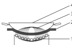
Un champ magnétique est activé dans l'appareil. En plaçant sur une zone de cuisson une casserole avec un fond en fer, un courant à induction va se présenter dans le fond de la casserole. Ce courant à induction génère de la chaleur dans le fond de la casserole.
