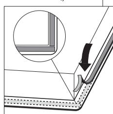
Retirez le film de protection de la bande d'obturation et collez cette dernière dans la rainure des profils en aluminium et sur le bord de la plaque de verre. Pour une bonne finition des coins, coupez la bande d'obturation en 4 et ajustez-les bien dans les coins.
