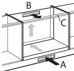
Вентиляция осуществляется через нижний вырез (A) и заднюю стенку шкафа (B). Вырежьте соответствующие вентиляционные отверстия (мин. 100 см<sup>2</sup>). Подача воздуха A является избыточной, если, наряду с отверстием B, имеется впускное воздушное отверстие в другом месте.
